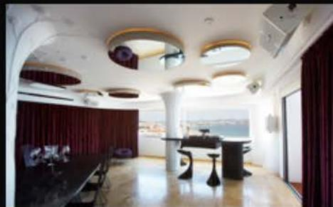
Трапециевидальная конструкция кабинетов позволяет подвесить их близко к потолку в горизонтальном положении, что помогает вписаться в дизайн комнаты. Система запитывается двумя усилителями Powersoft K-3 с пресетами Pioneer. Для настройки системы использовалась программа Rational Acoustics Smaart.
